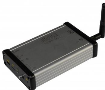
Il termoflussimetro per misure di trasmittanza in opera TLOG-WLS si caratterizza per la massima accuratezza nell'acquisizione dati (risoluzione 24 bit) unita alla grande versatilità e semplicità di impiego.
